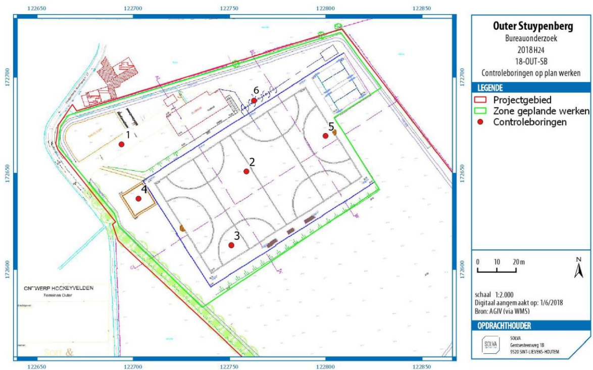
Figuur 23: Controleboringen op plan van de werken (bron plan: Gemeente Ninove; digitaal aangemaakt op 01/06/2018).
