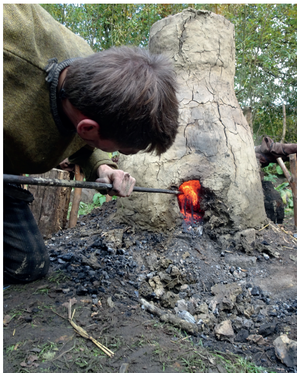
Reconstructie van een laagoven voor de productie van ijzer. © K. Boel & Smeedteam IJzerboerderij Dongen
