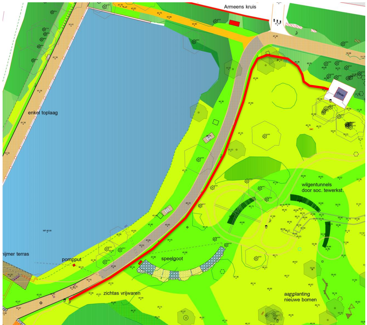
Fig. 31 Sleuf voor de nutsleidingen (rood) richting het Chinees paviljoen
