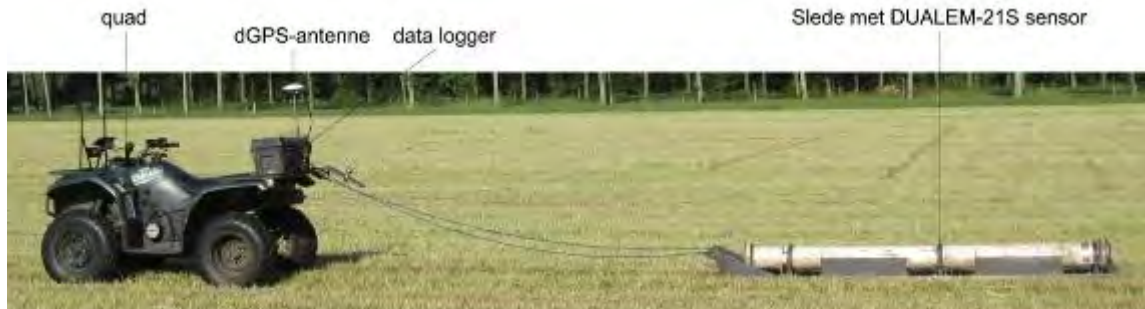
Foto 1. Mobile veldsetup gebruikt bij de survey te Ninove, ©ORBit.
