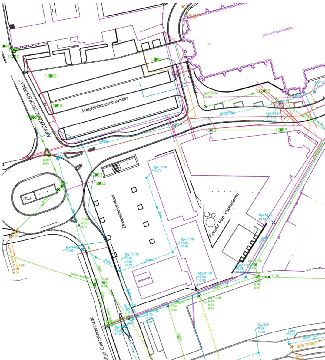
Figuur 45: nutsleidingen op en rond het Minderbroeders- en het Drosbekeplein geprojecteerd op het huidige kadaster.
