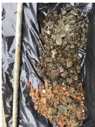
Foto 11: Foto van boring 1 zonder asfalt. Van 9 cm tot 50 cm diepte. Het bovenste donkere deel is duidelijk verstoord. Het onderste deel van de boring zouden niet verstoorde lagen kunnen zijn. (Bron: Pardon 2022)
